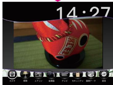
画面左右から紫色の曲線を徐々に出現させ、交差させる。2つの曲線は予め VRAM 内に作成しておき、AG903 のウィンドウ機能で表示する位置と範囲を逐次設定する。各曲線は、EGL で上側曲線と下側曲線の描画サーフェスを作成し、背景を  $\alpha=0$  (透過) で塗りつぶした上、VGPath オブジェクト (ベジェ曲線) で作成する。
