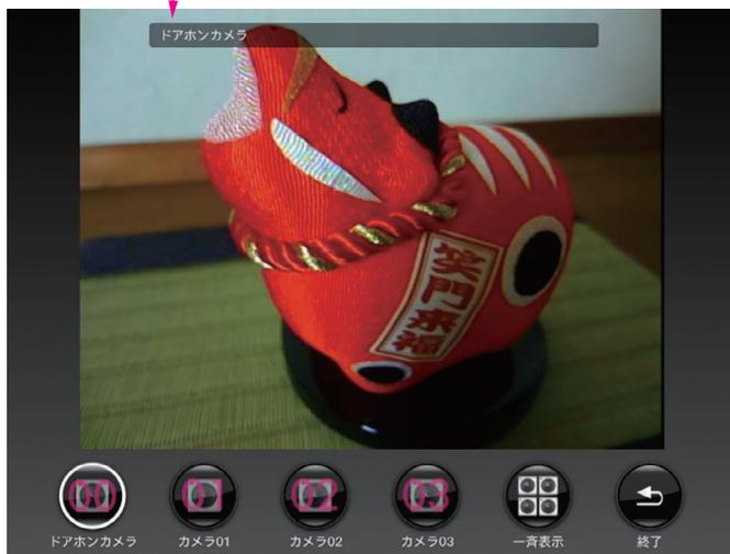
カメラ画面の背景は凹型の `VGPath` オブジェクトを作成し、上に行くほど黒くなるリニアグラデーションの `VGPaint` オブジェクトで塗りつぶす。ビデオキャプチャの表示は AG903 のウィンドウ機能による合成で表示するため、ビデオキャプチャの領域は  $\alpha=0$ (透過)にして `vgClear` で塗りつぶす。画面中央上側に選択中のカメラ名をビデオキャプチャ画像に重ねて表示させるため、描画サーフェス用ウィンドウ(Win#0)の下にビデオキャプチャ用ウィンドウ(Win#1)を重ねる。
