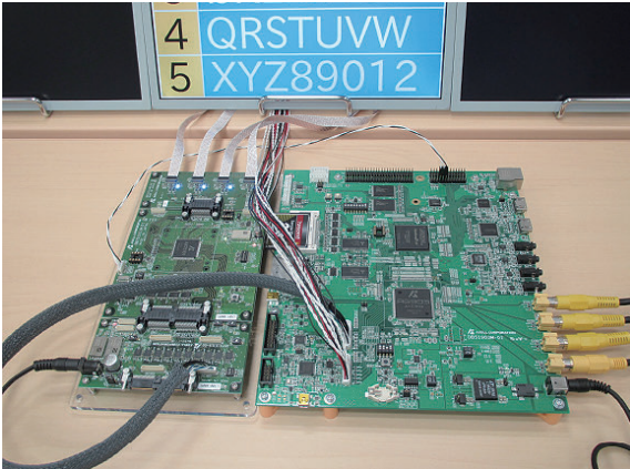
写真 5-6 画面分割用基板 (左) と AG903 評価ボード (右)
