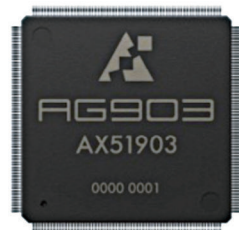
写真 3-1 AG903 の外観 パッケージは QFP 256 ピン。
