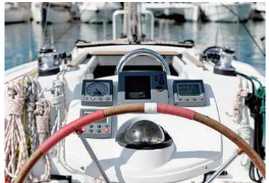
屋外、海上などさまざまな作業現場で、さまざまな機械や装置が使われている。複雑な情報の確認や難しい制御が必要なものも多い。操作の負担を減らすために、針式の計器と機械式の操作ボタンから、見やすく操作しやすい GUI の表示 / 操作パネルに進化を続けている。
