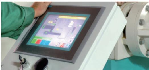
工場内では、システムに合わせて製作した操作盤や、個々の機器がもつ表示/操作パネルが数多く使われている。このようなパネルでは、画像表示機能やディスプレイ I/F、タッチパネル I/F、カメラ I/F、機器接続用の汎用 I/F を備えた SoC を活用して、小型化と高機能化を実現している。
